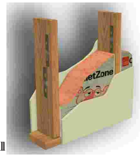
Single Layer Gypsum Drywall
